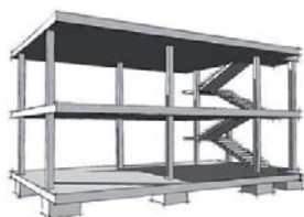
(Figura 1. Esqueleto estrutural da Casa Domino, Le Corbusier, 1914. A estrutura independente das paredes (vedações) resulta em uma planta livre, o que torna possível planejar ambientes diferentes para um mesmo local, ou seja, diferentes formas de compartimentação).
