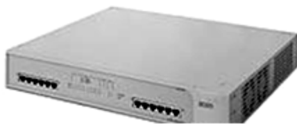
Switch 3Com com 8 portas
